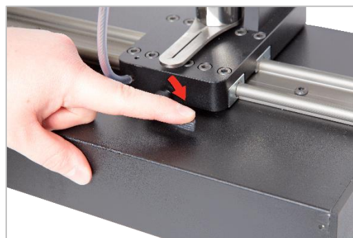
FIGURE 13 - Ajustement et réglage du levier de verrouillage
