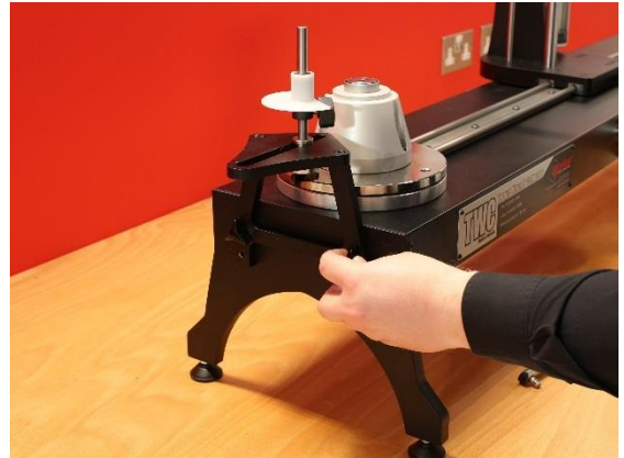
FIGURE 28 - Fixation de la plaque de réaction courte
