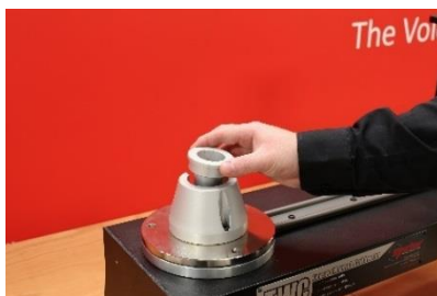
FIGURE 27 - Installation du Kit de support de la sonde statique
