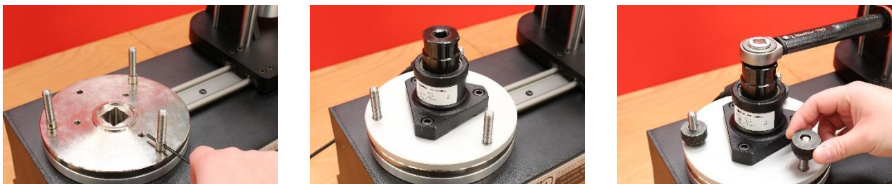
FIGURE 31 - Fixation du kit de montage rapide FMT
