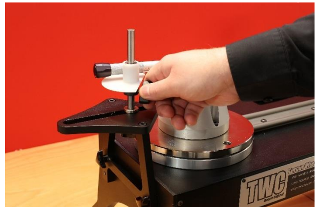
FIGURE 29 - Réglage du point de réaction des plaques de réaction courtes
