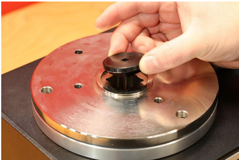
FIGURE 26 – Insertion de l'adaptateur carré
