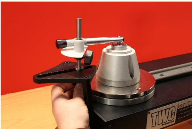
FIGURE 29 - Réglage du point de réaction des plaques de réaction courtes
