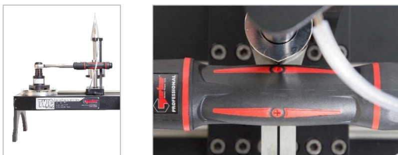
FIGURE 16 - Mise en place d'une clé dynamométrique
