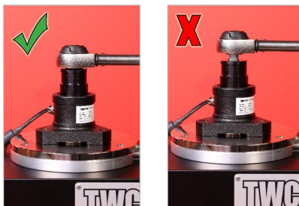
FIGURE 15 - Fixation d'une clé dynamométrique
