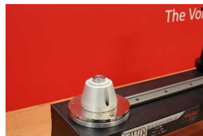
FIGURE 27 - Installation du Kit de support de la sonde statique
