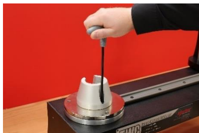
FIGURE 27 - Installation du Kit de support de la sonde statique
