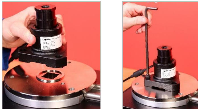
FIGURE 14 - Pose d'une sonde FMT
