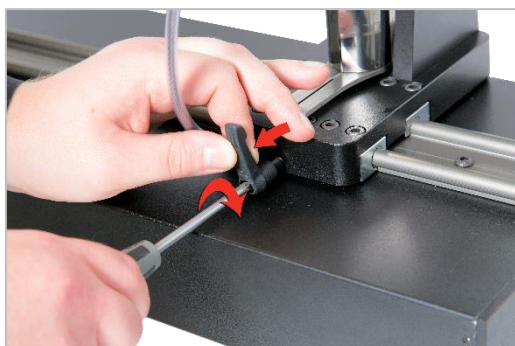
FIGURE 13 - Ajustement et réglage du levier de verrouillage
