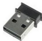
Una volta inserito, questo adattatore USB appare come una porta seriale invece che come un dispositivo Bluetooth®. Questo serve a rendere più semplice interfacciarsi con esso nel software e a evitare l'interferenza con l'hardware e il software Bluetooth® esistenti che potrebbero essere installati nel sistema.
