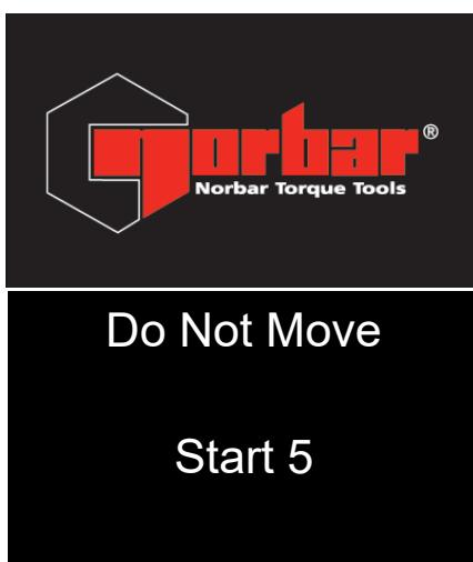
Compte à rebours de 5 secondes avant le calcul de la dérive du gyroscope.
