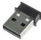
Une fois inséré, l'adaptateur USB apparaît sous la forme d'un port série plutôt qu'un appareil Bluetooth®. Vous pouvez ainsi communiquer plus facilement avec l'interface logicielle et éviter les interférences avec le matériel Bluetooth® et les logiciels éventuellement installés sur le système.
