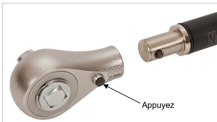
**REMARQUE :** Tous les outils NorTronic® sont des poignées dynamométriques équipées d'un fausset de 16 mm. Si vous souhaitez changer pour un autre raccord d'extrémité de clé, appuyez sur le piston situé sur la tête de cliquet et tirez pour le relâcher.
