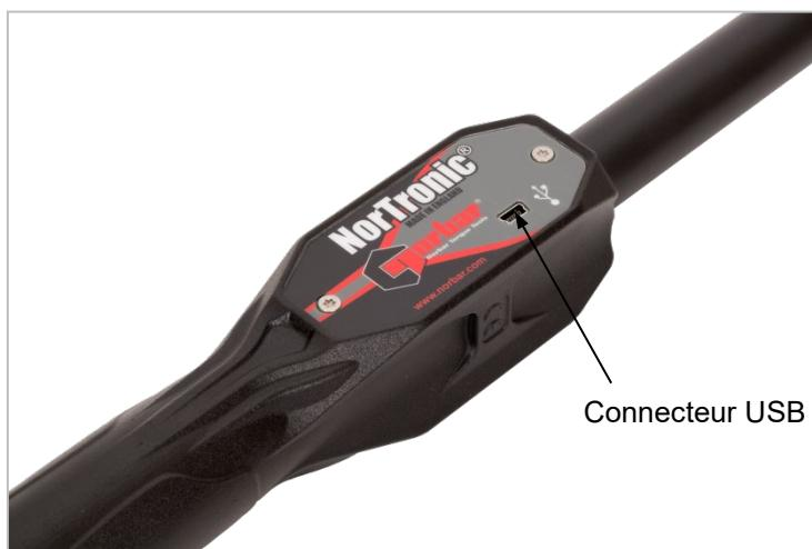
Les **Test Results (résultats de test)** enregistrés sur l'outil NorTronic® dans le **Data Store (banque de données)** seront copiés dans TDS lors de la synchronisation. La **Tool Target (cible de l'outil)** et la **Tool SETUP (PARAMÈTRES de l'outil)** peuvent également être envoyées depuis le TDS.
