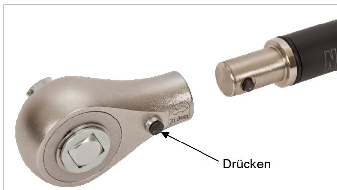
**HINWEIS:** Alle Werkzeuge von NorTronic® sind Drehmomentgriffe mit einem 16 mm langen Zapfen. Wenn Sie einen anderen Schraubenschlüsselendeinsatz verwenden möchten, drücken Sie den Knopf am Ratschenkopf und ziehen Sie den Ratschenkopf ab.
