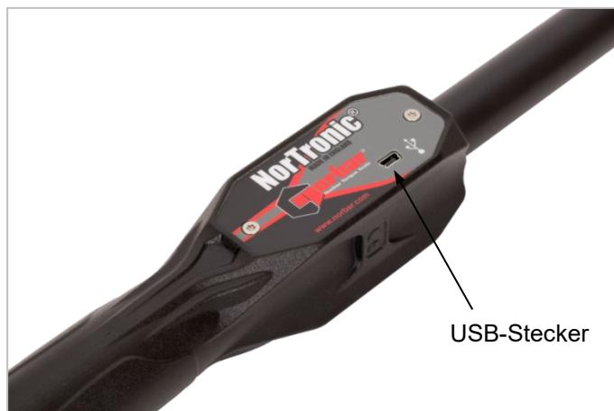
Auf dem NorTronic® (in dessen **Datenspeicher**) gespeicherte **Prüfergebnisse** werden bei der Synchronisierung in das TDS kopiert. Der **Zielwert des Werkzeugs** und die Einstellungen unter **Werkzeug-SETUP** können ebenfalls vom TDS übertragen werden.
