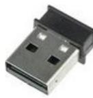
Nach dem Einstecken erscheint dieser USB-Adapter als serieller Anschluss anstelle eines Bluetooth®-Geräts. Dies soll es Ihnen erleichtern, sich mit ihm in der Software zu verbinden, und verhindern, dass er in die bestehende Bluetooth®-Hardware und -Software eingreift, die auf dem System installiert ist.
